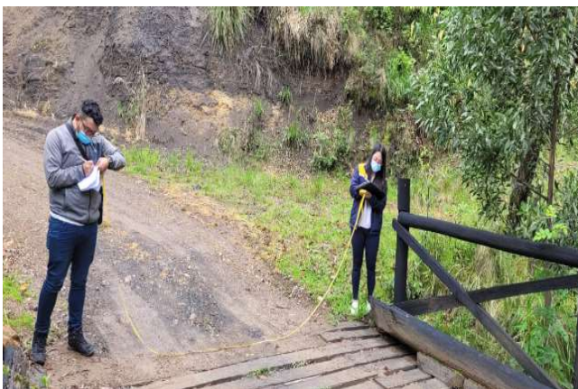
Verificación de ancho de Puente- Inventario Vial Parroquia San Cristóbal – Cantón Paute
